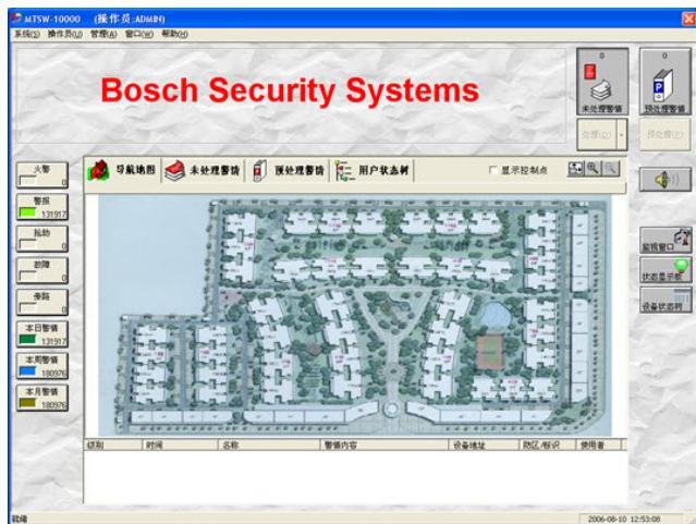
MTSW 是博世专门为国内广大用户需求而开发的中文多媒体专业报警处理与管理软件。该软件以可靠性为核心，使用方便，扩展灵活，具有良好的人机界面，具有报警功能。通过电脑串口或 IP 网络连接相应的保安系统设备，在同一的多媒体电脑平台上进行集中管理，并可以通过继电器输出板或软件通讯口输出来实现与 CCTV 系统的联动，提高整个系统的自动化程度和保安管理中心的工作效率。
