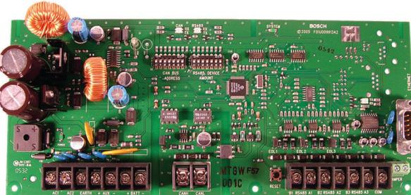
在博世安保系统有限公司多用户系统 (MTS) 中，MTGW CAN RS-485 总线网关用于将通过 RS-485 总线发送的数据转换为控制器局域网络 (CAN) 总线可使用的格式，并将 CAN 总线数据转换为 RS-485 总线可使用的格式。此数据包括已连接到 RS-485 总线的设备发生的事件以及从多用户中心接收器 (MTR) 发送到设备的命令。MTGW 最多可缓存 64 个事件以供转换。此外，它还监视整个 CAN 和 RS-485 节点的连接状态。每个 MTGW 具有三路独立 RS-485 总线。MTGW 具有一个用于升级固件的 RS-232 界面。
